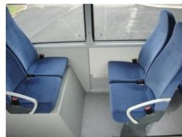
51 sièges fixes de marque BRUSA type Divide dont 2 sièges PMR + 4 sièges à assises relevables, Coques AR anti vandalisme, barre d'arrêt de cartable, Poignée de circulation, cale hanche. Horloge digitale avec indicateur de température extérieure.
